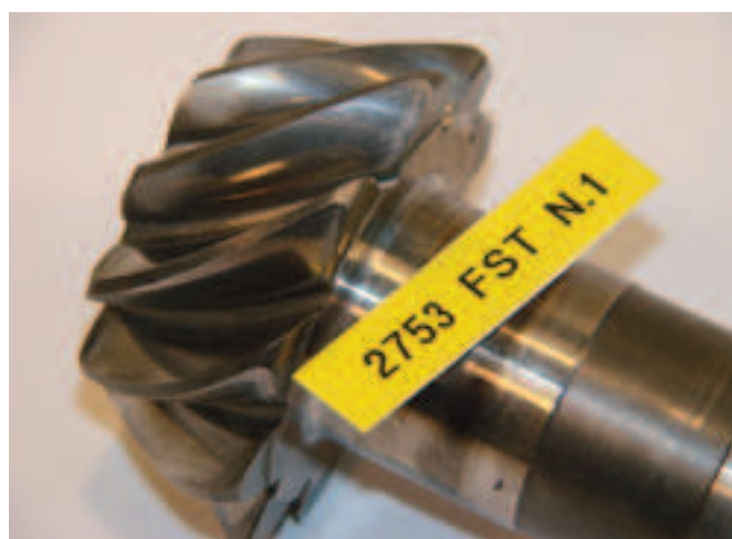
Figure 3 - Usure dent du pignon conique Carraro ORIGINAL à la fin du test
