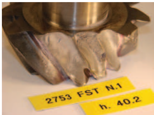
Figura 2 - Rottura base denti pignone NON ORIGINALE
