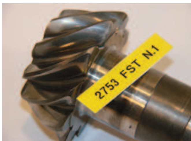
Figura 3 - Desgaste de los dientes del piñón ORIGINAL Carraro al final del test
