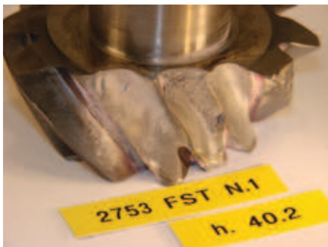
Figura 2 - Quebra da base dos dentes do pinhão NÃO ORIGINAL
